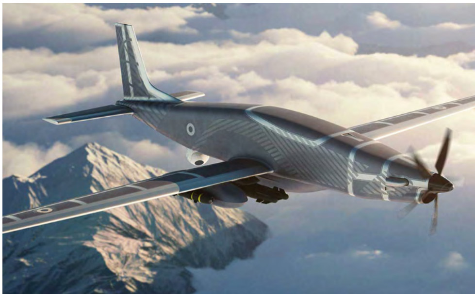
Wizualizacja seryjnego Aaroka. Widoczna głowica stacji optoelektronicznej. Pod centroplatem wystaje owiewka radaru. Pod skrzydłem są dwie 500-funtowe bomby kierowane AASM i jeden pocisk à la Hellfire. Podskrzydłowe gondole goleni podwozia głównego mają też mieścić wyposażenie SIGINT. Fot. Turgis & Gaillard
