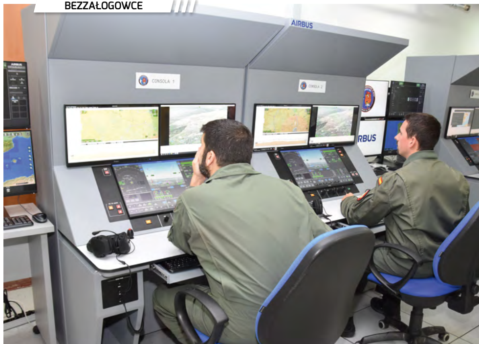
Airbus razem z MALE RPAS oferuje swój uniwersalny (symuluje misje ISTAR na dowolnym typie BSP od kategorii mini po MALE) cyfrowy trener SE-RPAS, spełniający NATO-wskie wymagania STANAG 4586, i będący ITAR-free. Na zdjęciu stanowiska kursantów, które uzupełnia stanowisko instruktora. Fot. Airbus
